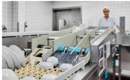
Ergonomisch eingetaktet: Teller und Schüsseln werden im M-i-Flow gewendet. Speisereste entfernt und dann automatisch in die Spur eingetaktet.
