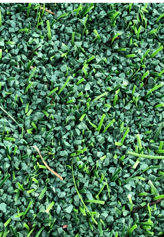
Kunststoffgranulat aus EPDM (Ethylen-Propylen-Dien-Kautschuke).
