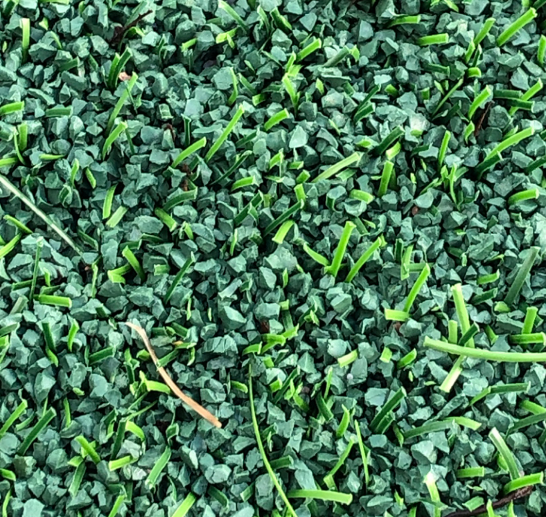
Kunststoffgranulat aus EPDM (Ethylen-Propylen-Dien-Kautschuke).
