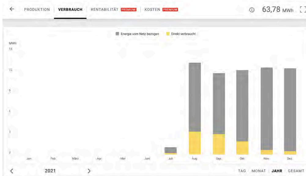
GRAPHIK 3. VERBRAUCH SOLARENERGIE 2021. DER AKTUELLE ENERGIEVERBRAUCH LIEGT NOCH ÜBER DEM SELBSTERZEUGTEN SOLARSTROM, SO DASS WEITERHIN ÜBER DAS LOKALE NETZ BEZOGEN WIRD.
