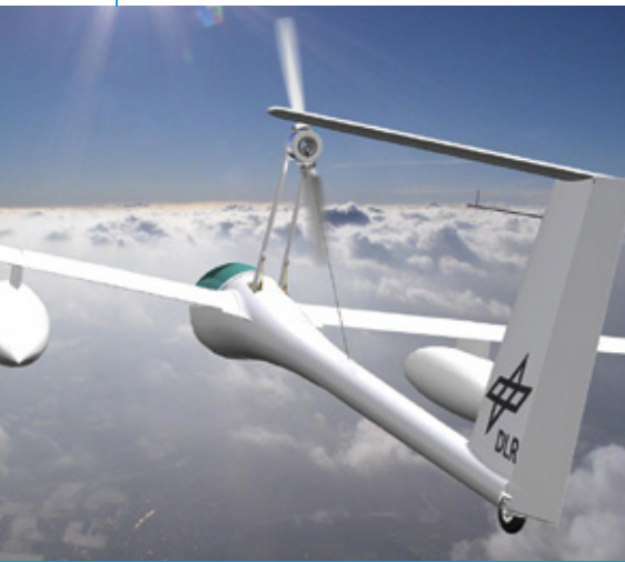
Wasserstoffbetriebene Brennstoffzellen für den Antrieb eines Motorseglers
