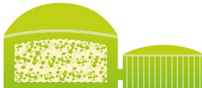
Fermenter mit Gasspeicher
